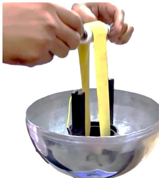
4. Откройте крышку лючка обслуживания, рукой снимите резиновую ленту с приводного ролика.
