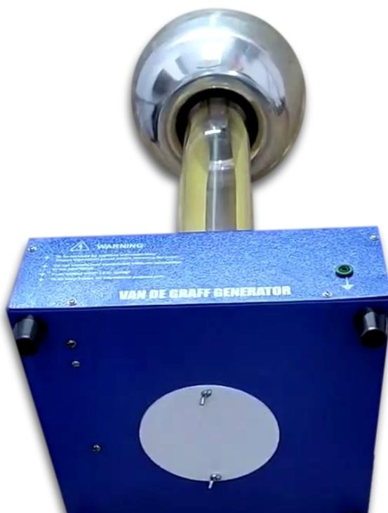
2. Снимите крышку полусферы и ослабьте крепление верхнего ролика.
